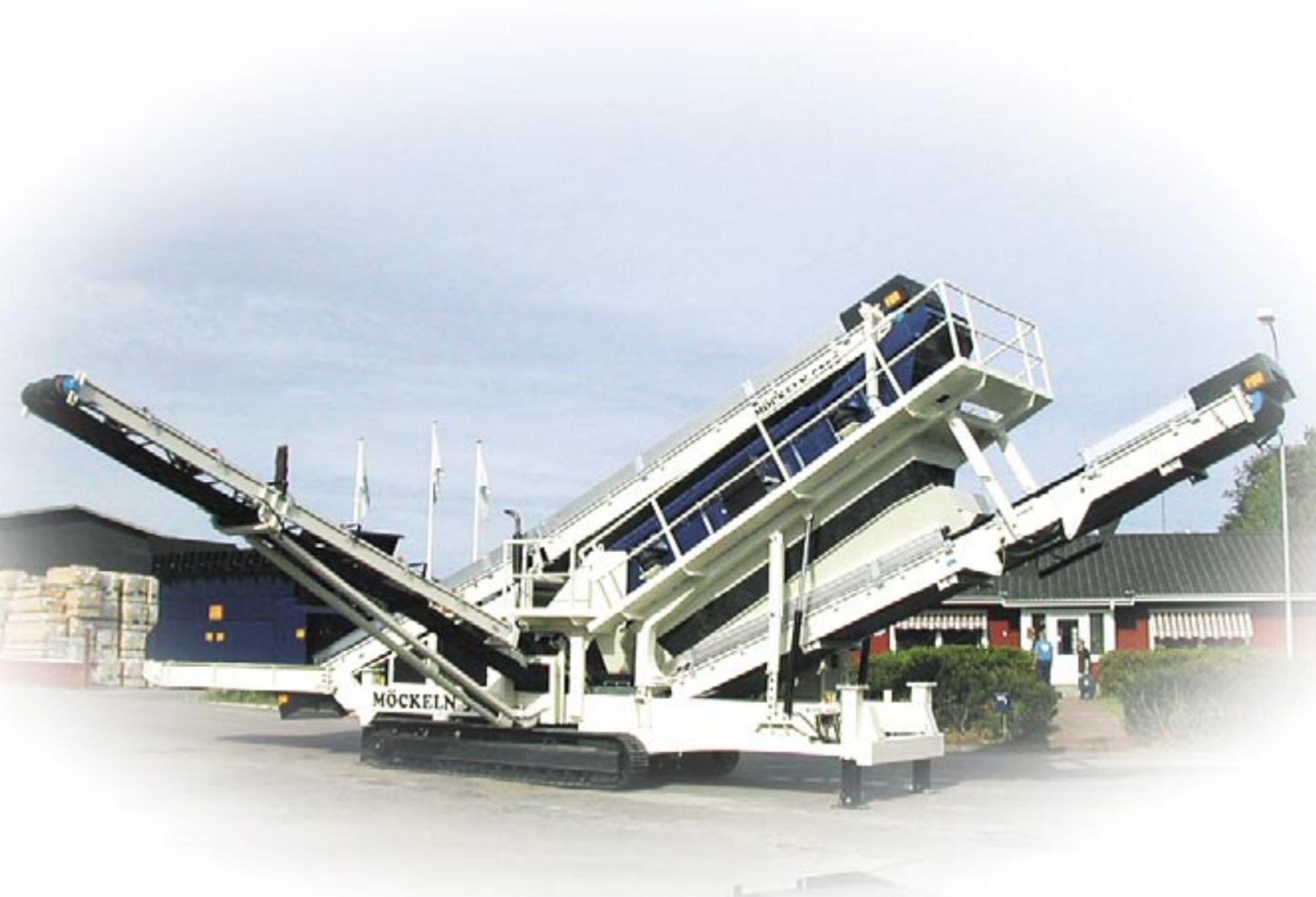
Eurotrack 5200 är den senaste av Möckelns mobila sorterare, larvburen, anpassad för dagens höga krav på kvalitetssiktning. Med bolldeck kan vi uppnå ett mycket gott resultat, ner till 3 mm vid siktning på kvadratisk maska.
