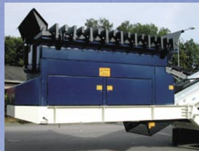
Bandmatare med plant galler för låg ilastningshöjd. Kan även levereras med vibrationsmatare.
