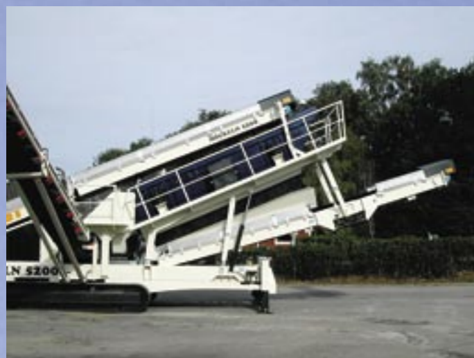
Siktstorleken är 5200x1500 mm, dubbeldäckad, tvångsstyrd, vilande på 4 st luftgummidämpare. Hydraulisk justering av siktinkel. Transportören för finfraktion har justerbar vinkel. För åtkomst av sikten underifrån kan man enkelt lägga transportören horisontellt.
