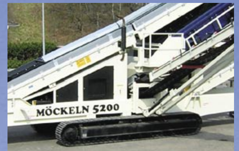
Dieselelektrisk för säker drift. Kan även levereras för nät drift.
